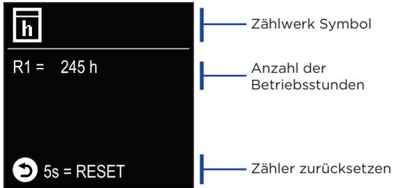
Durch 5 Sekunden langes Drücken der Taste
