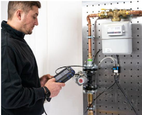
Ein eigener Menüpunkt sorgt dafür, dass die Funktionsfähigkeit des Gasreglers in wenigen Minuten getestet werden kann.
