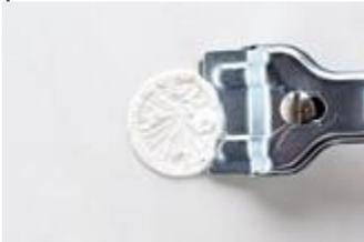
+ Haftmittelrückstände mit Glasschaber entfernen, bei rauen Oberflächen unter Zuhilfenahme von Silikonentferner oder Aceton und Wurzelbürste.
