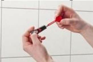
Mit Hilfe des Schlüssels Tubenspitze aufstechen, Tubenende um einen Falz entfalten, in Schlüssel einfädeln und wieder um einen Falz aufrollen.
