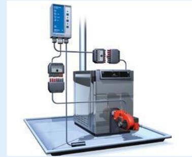
**Anwendung** Zur optischen und akustischen Meldung von Flüssigkeitsansammlungen unter dem Brenner einer Heizölanlage und Abschaltung des Brenners im Alarmfall. Geeignet für die Medien Wasser, Heizöl und Dieselkraftstoff. Weitere Flüssigkeiten siehe Betriebsanleitung. Einsatz als Leckanzeigesystem der Klasse III nach EN 13160-1/-4 sowie als Sicherheitseinrichtung nach Arbeitsblatt DWA-A 791 und nach Arbeitsblatt DWA-A 779.
