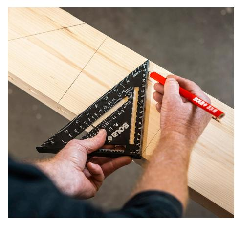
Die Vielzahl an Skalen und Aussparungen eignen sich ideal zum Markieren von Linien und Winkeln. Dank der robusten Kante kann der Sparrenwinkel als Sägeführung verwendet werden.
