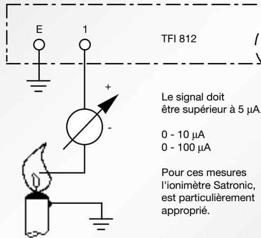
Le signal doit être supérieur à 5 µA.
