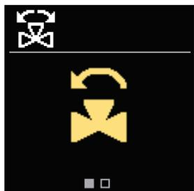
Sélectionnez le sens d'ouverture de la vanne mélangeuse. Utilisez les touches  $\ominus$  et  $\oplus$  pour naviguer entre les sens. Confirmez le sens sélectionné avec la touche  $\odot$ .
