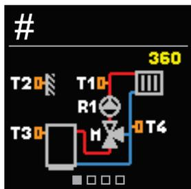
Choisissez le schéma hydraulique pour le fonctionnement du régulateur. Pour naviguer entre les différents schémas, utilisez les touches  $\ominus$  et  $\oplus$ . Confirmez le choix du schéma avec la touche  $\odot$ .
