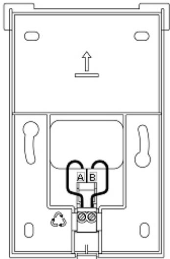
Socle de raccordement (partie supérieure enlevée)
