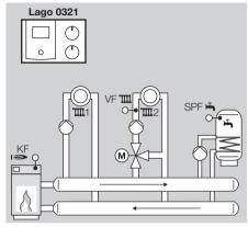
Raccorder sonde générateur (KF/KFS), sonde départ (VF/VFAS) et sonde E.C.S. (SPF/SPFS), paramètre 38 = "----" (aucune adresse module chaudière)
