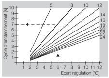
Avec un écart de température de 6 °C, la vanne est pilotée durant 7 s et reste à l'arrêt pendant 3 s.
