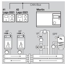
Cette application se configurera automatiquement dès que vous aurez raccordé une sonde chaudière (KF/KFS) et réglé le paramètre 38 = 1 –8 (adresse module chaudière).
