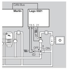
La vanne se trouvant dans le circuit fonctionne en tant que vanne bipasse. La vanne s'ouvre (ON). La pompe est enclenchée.
