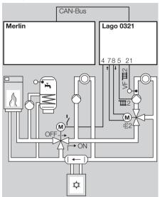
Le régulateur central Merlin 5064 active le "mode rafraîchissement" via le bus de communication CAN et pilote le générateur, la PAC, la préparation d'E.C.S. et le circuit direct. Le régulateur Lago 0321 pilote la vanne bipasse et le circuit vanne. P80 = 34. P74 = 20 °C
