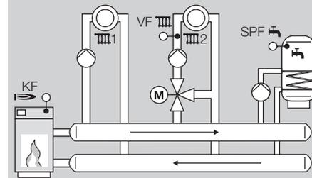
Raccorder sonde générateur (KF/KFS), sonde départ (VF/VFAS) et sonde E.C.S. (SPF/SPFS), paramètre 38 = „----“ (aucune adresse module chaudière)
