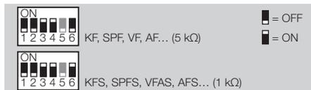
Pour raccorder une télécommande, régler l'interrupteur Dip 5 :
