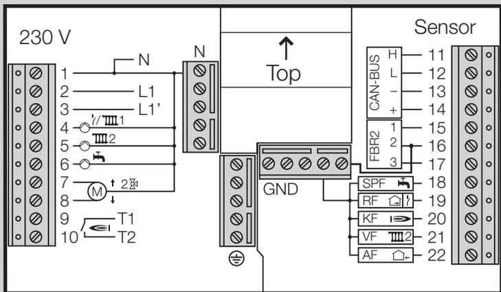
230 V~, capacité de coupure des relais 2 A, 250 V~
