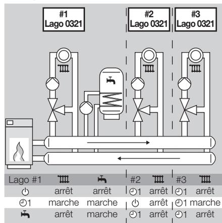
Installation à trois circuits vanne et préparation d'E.C.S. : Lago #1 règle le premier circuit et l'E.C.S. Lago #2 règle le deuxième circuit et Lago #3 le troisième. Si le régime **Ø** a été sélectionné pour Lago #1, l'installation entière est arrêtée, et ce quel que soit le réglage des autres régulateurs.
