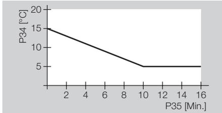
Le différentiel est réduit de 15 °C à 5 °C sur une durée de 10 min.
