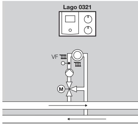
Si une seule sonde départ est raccordée (VF/VFAS), cette application se configurera automatiquement.
