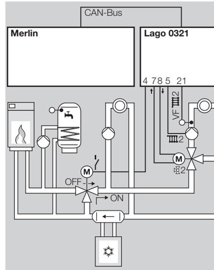
Le régulateur central Merlin 5064 active le „mode rafraîchissement“ via le bus de communication CAN et pilote le générateur, la PAC, la préparation d'E.C.S. et le circuit direct. Le régulateur Lago 0321 pilote la vanne bipasse et le circuit vanne. P80 = 34, P74 = 20 °C
