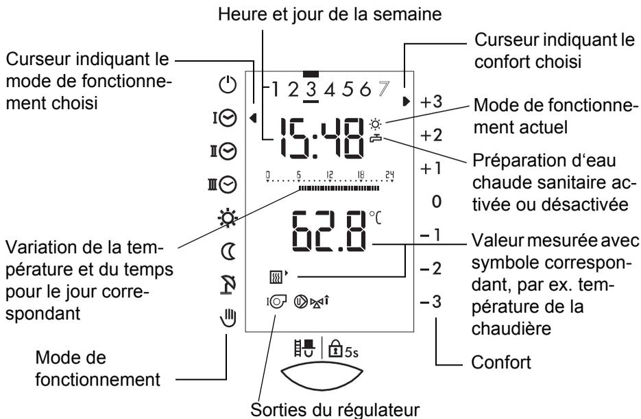
La figure montre le display avec tous les symboles pour le contrôle (volet ouvert, 2ème niveau de commande).
