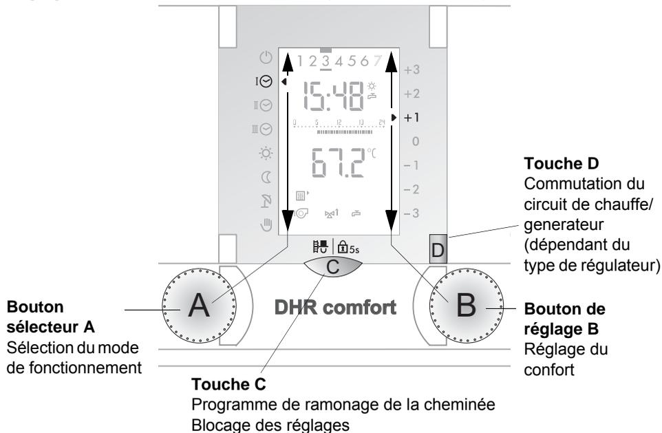
Réglages au 2ème niveau de commande (**volet avant ouvert**)
