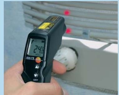
Sichere Messungen durch Messfleckmarkierung mit Laserstrahl
