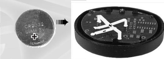
Batteriewechsel wird erforderlich, wenn während der Messung das Symbol in der Anzeige erscheint. Gehäuse mit Hilfe eines Schraubendrehers öffnen. Verbrauchte Knopfzelle herauschieben. Neue Knopfzelle einlegen - **Polung beachten!**
