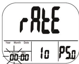
Fig. 30: Réglage du taux d'échantillonnage (heures)
