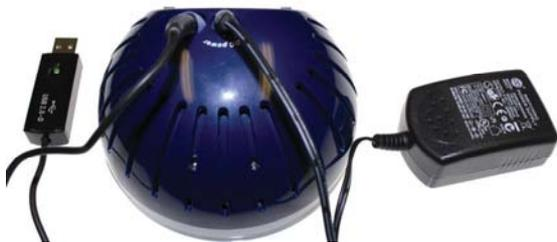
Fig. 5: Connexion du bloc d'alimentation électrique y câble USB au revers de l'appareil
