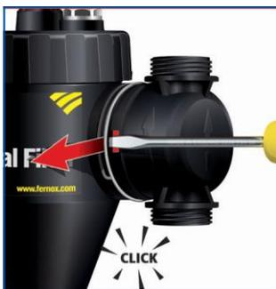
Mit einem flachen Schraubenzieher den Verriegelungs-Clip in der abgebildeten Vertiefung vorsichtig auf die Position „Entriegeln“ stellen.
