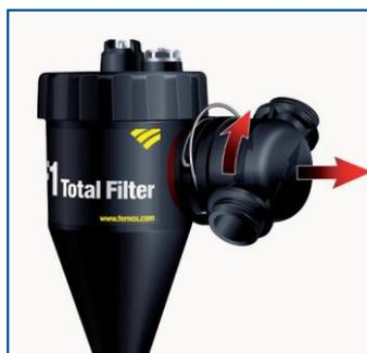
Den Einlass-/Auslassport ca. 3 mm aus dem Gehäuse ziehen, um eine Drehung in die gewünschte Position zu ermöglichen.
