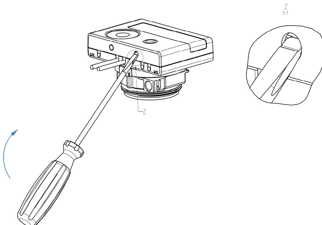
Incérez le module d'interface sur le côté droit de la platine. S'il y a des câbles, passez-les à travers les orifices en bas à droite du boîtier après avoir enlevé les opercules. Refermez le calculateur.
