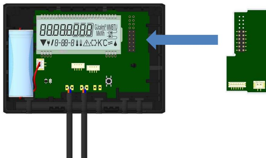
Pour retirer un module, ouvrir le calculateur comme décrit ci-dessus. Tout en ouvrant le calculateur, pressez méticuleusement l'arrête supérieure du couvercle contre l'arrête supérieur du boîtier (partie noire). Ainsi, les deux fixations à l'arrière du couvercles soulèvent le module de la platine (voir image 4).
