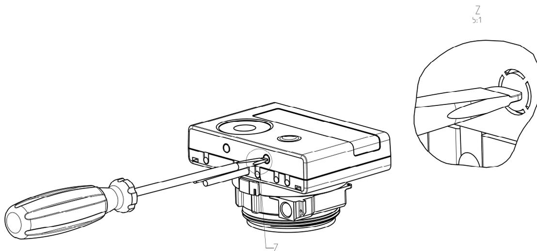
Ensuite, introduire le tournevis dans l'une des deux ouvertures à un angle d'env. 45° et le soulevez prudemment jusqu'à env. 90° (voir image 2). La partie supérieure du boîtier du calculateur n'est alors plus verrouillée de ce côté. Répétez cette opération avec l'autre ouverture. Maintenant, la partie supérieure du boîtier peut être retirée.
