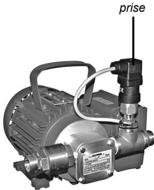
Le contacteur manométrique met à l'arrêt la pompe si la pression atteint une valeur pré-réglée à 3 bar (seuil supérieur). Si la pression retombe en dessous d'un certain seuil (seuil inférieur), la pompe redémarre automatiquement. L'hystérésis des seuils de commutation est réglé en usine à 30%.
