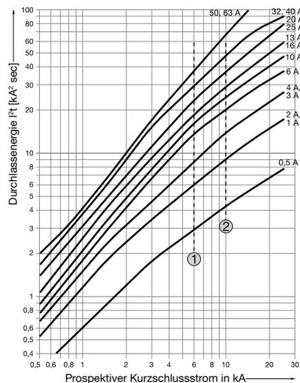
**Maximalwerte des Durchlassstromes bei Kurzschlussabschaltung**
