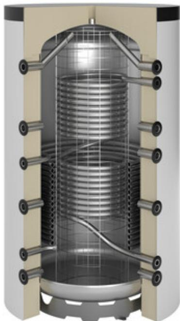
Ballon d'eau fraîche répondant aux exigences les plus élevées en matière d'hygiène de l'eau potable et d'efficacité énergétique. La structure du ballon se distingue fondamentalement des ballons d'eau sanitaire habituels de grand volume. Un tube ondulé en acier inoxydable intégré sépare l'eau potable de l'eau de chauffage et sert également d'échangeur thermique performant. Les avantages d'un ballon tampon sont ainsi combinés à ceux d'un chauffe-eau instantané.
