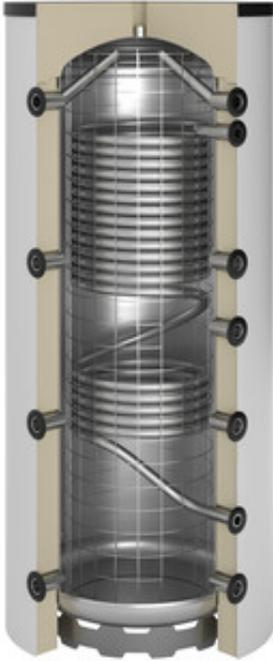
Ballon d'eau fraîche répondant aux exigences les plus élevées en matière d'hygiène de l'eau potable et d'efficacité énergétique. La structure du ballon se distingue fondamentalement des ballons d'eau sanitaire habituels de grand volume. Un tube ondulé en acier inoxydable intégré sépare l'eau potable de l'eau de chauffage et sert également d'échangeur thermique performant. Les avantages d'un ballon tampon sont ainsi combinés à ceux d'un chauffe-eau instantané.
