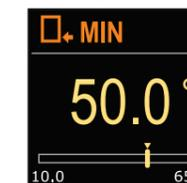
Déterminez la limite inférieure du réglage possible de la température souhaitée en mode chauffage avec les touches et . Confirmez le réglage en appuyant sur la touche . Si vous avez sélectionné une limite inférieure par erreur, vous retournez à la sélection de la limite inférieure en appuyant sur la touche .
