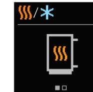
Sélectionnez le mode de fonctionnement souhaité - chauffage ou refroidissement avec les touches et . Confirmez le mode de fonctionnement sélectionné avec la touche . Si vous avez sélectionné un mode de fonctionnement par erreur, vous retournez à la sélection du mode de fonctionnement en appuyant sur la touche .
