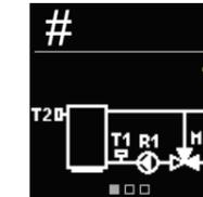
Sélectionnez le schéma hydraulique pour le fonctionnement du régulateur. Faites défiler les schémas en appuyant sur les touches et . Confirmez le schéma sélectionné en appuyant sur la touche . Si vous avez sélectionné un schéma par erreur, vous retournez à la sélection du schéma en appuyant sur la touche .
