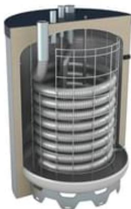
La mise en place des ballons d'eau fraîche instantanées OEG se différencie grandement des ballons usuels à grand volume. Un serpentin intégré sépare l'eau sanitaire de l'eau de chauffage et sert en même temps d'échangeur thermique puissant. Les avantages d'un ballon tampon et celui d'un chauffe-eau instantané sont combinés.
