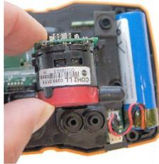
2 Schlauchverbindungen vom defekten Sensor der Brücke abziehen.
