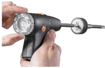
2 Filterkammer entfernen.
