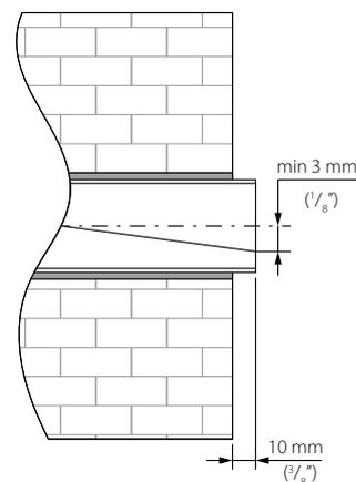
2. Faites le poinçonnage des orifices pour la fixation du chapeau de ventilation extérieur et percez 4 orifices pour les clous de 6x40 sur la profondeur de 50 mm.
