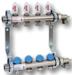
Rundrohrverteiler aus Edelstahl für 2-12 Heizkreise zur Verteilung, Absperrung und Einregulierung des Heiz-/Kühlwasserstroms von Flächenheizungen/-Kühlungen in Übereinstimmung mit DIN EN 1264-4. Durchfluss durch je ein einstellbares Regulierventil mit Absperrfunktion pro Heizkreis im Rücklauf, stufenlos einstellbar. Das Schau glas im Verteiler-Vorlauf bietet zur Überprüfung eine optische Funktionskontrolle.
