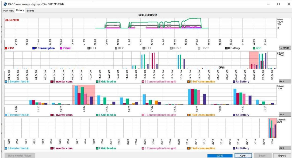
Das erste obere Liniendiagramm stellt die Minutenwerte der aktuellen Leistungen und Spannungen, sowie den Ladezustand der Batterie für einen Tag dar und kann für die Tagesverlaufsanalyse verwendet werden. Das Datum des angezeigten Tages befindet sich links oben in dem Diagrammfeld. Durch Drehen des Maus-Rades kann durch die Tage gescrollt werden.
