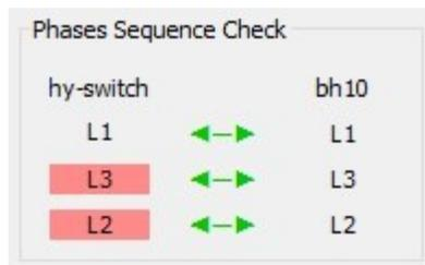
Anzeige bei fehlerhafter Drehfeldrichtung (rot beleuchtet)
