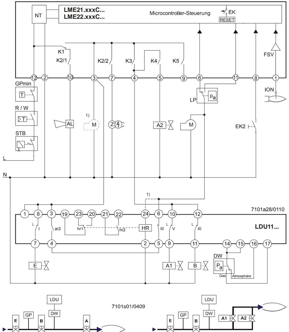
1) In Verbindung mit Gebläsemotor an Klemme 3 von LME21.xxxC... / LME22.xxxC...
