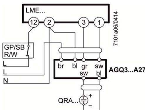
Messschaltung zur Messung des UV-Flammenstroms
