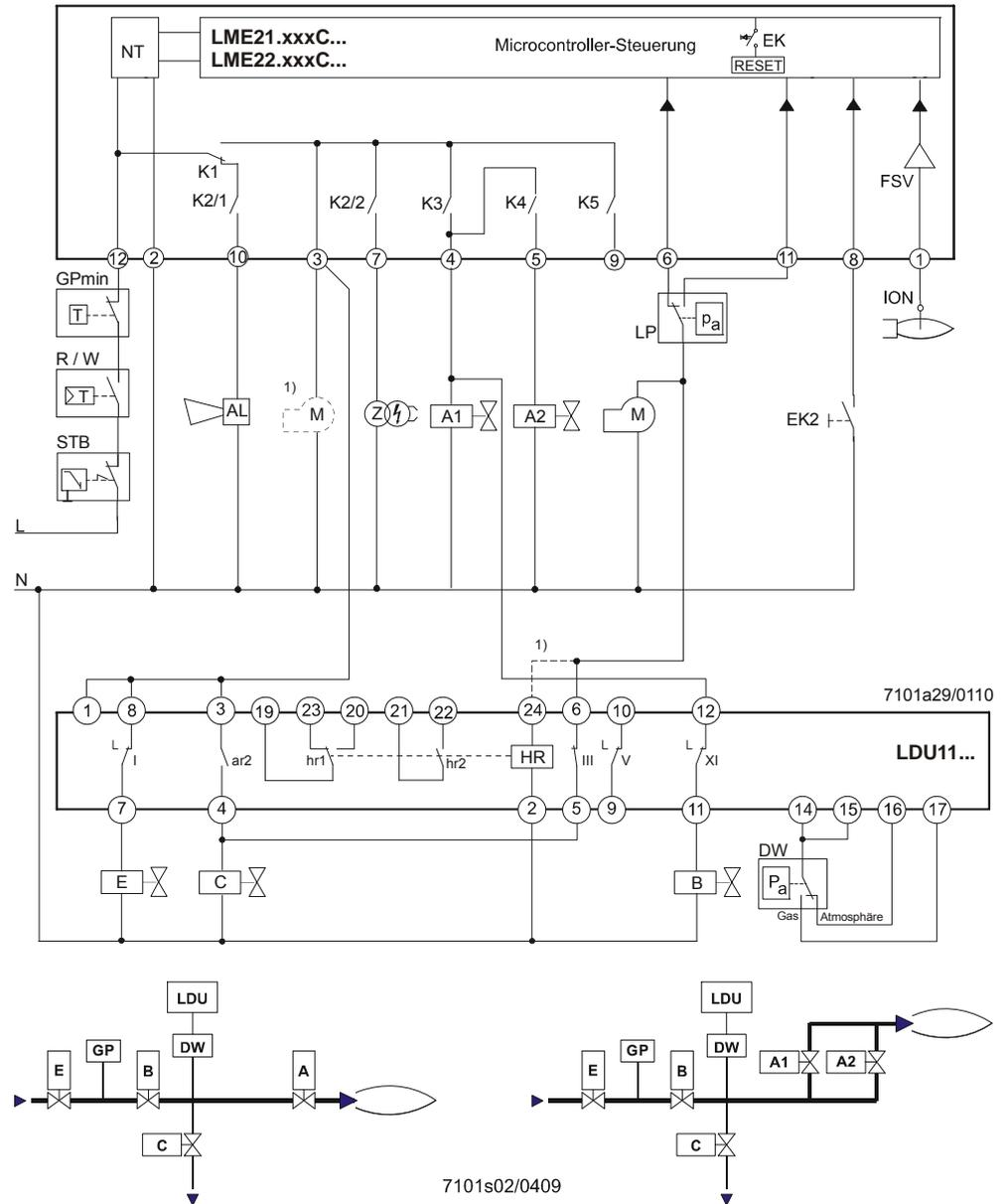
1) In Verbindung mit Motor an Klemme 3 von LME21.xxxC... / LME22.xxxC...
