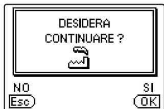
Il regolatore richiede che sia confermata l'impostazione della curva climatica con il tasto **OK**. Se per errore è stato impostato un valore errato della curva climatica, impostarlo nuovamente con il tasto **Esc**.
