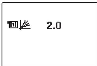
Impostare l'inclinazione della curva climatica per il primo circuito di riscaldamento.
