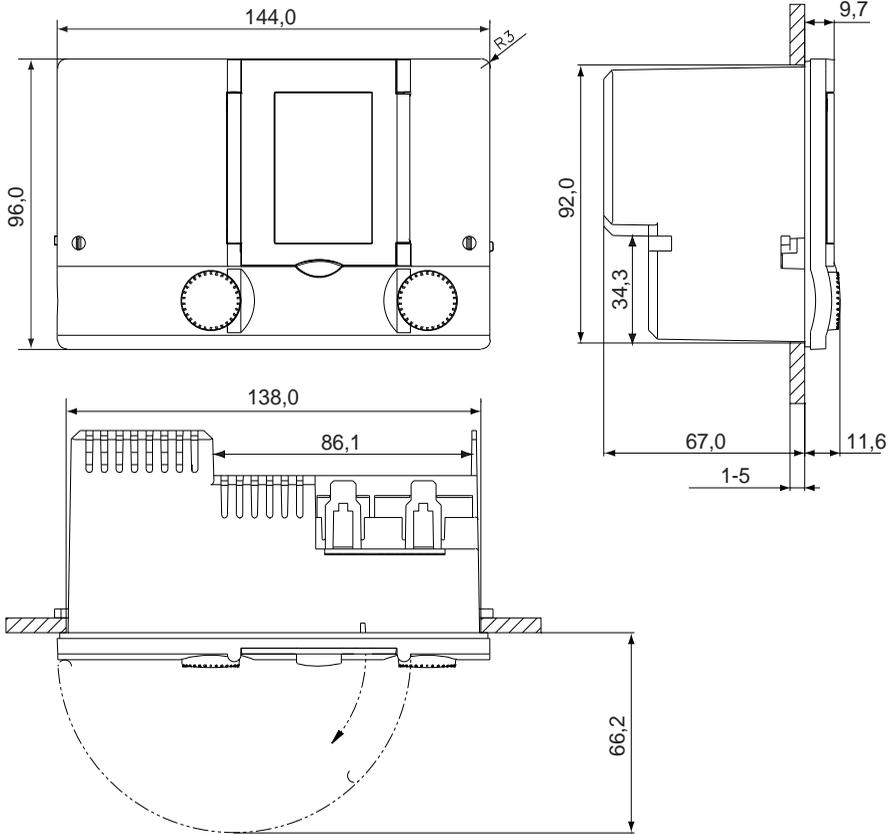
Der Einbauausschnitt beträgt 92 (-0/+1) x 138 (-0/+1) mm gemäss DIN 43700.
