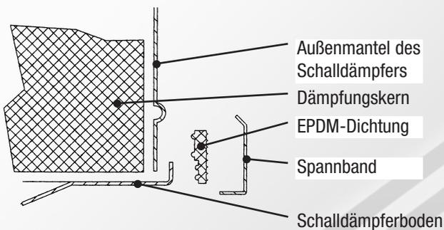
Die Böden der Schalldämpfer sind über Spannänder und einer darunter liegenden Dichtung mit dem Außenmantel verbunden (außer bei der Typenreihe ARE).
