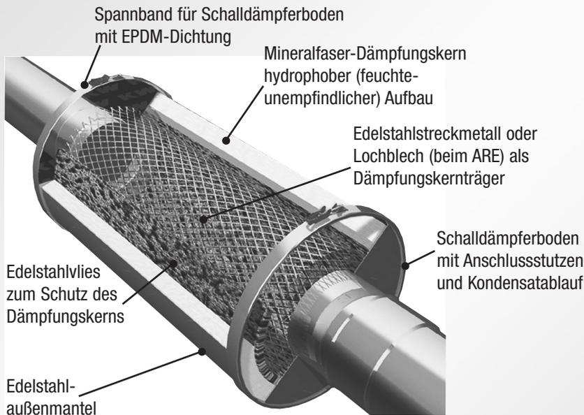
Die Schalldämpferkerne bestehen aus einem Streckmetallgeflecht, bzw. einem Lochblech bei der Typenreihe ARE, aus den Werkstoffen 1.4571/1.4404 und einem Edelstahlvlies als Abdeckung des Strömungskanals.
