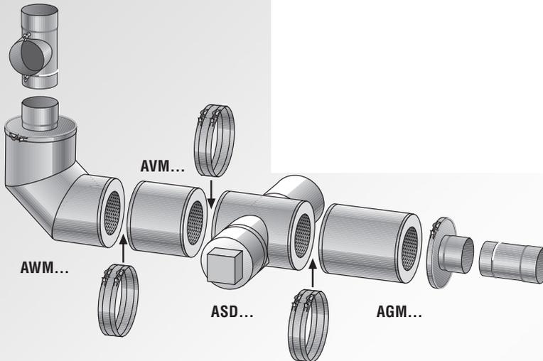
Die Schalldämpfertypen Aktiv+ (ASD), Passiv-Schalldämpfer (AGM), Verlängerungsschalldämpfer (AVM) und Winkelschalldämpfer (AWM) sind aufgrund ihrer Modulbauweise beliebig miteinander kombinierbar.
