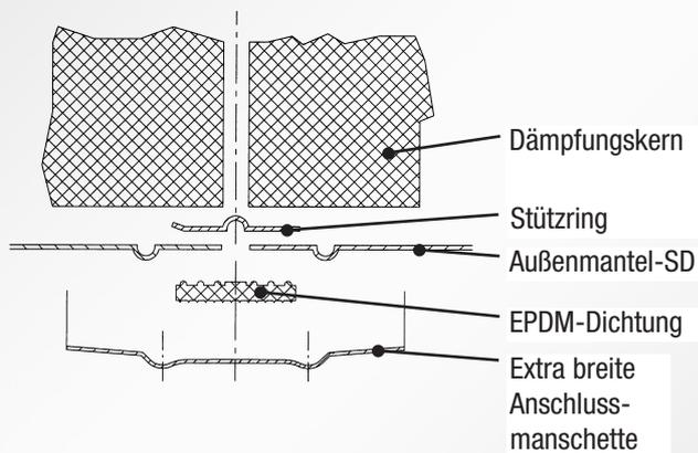
Für die Verbindung der einzelnen Module werden extra breite Anschlussmanschetten mit Stützring und Dichtung benötigt.
