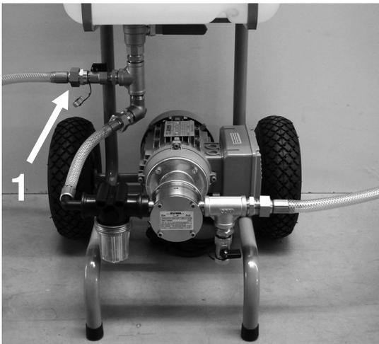
2. Zur Reinigung die Pumpe mit Wasser spülen. Dazu den Kugelhahn am Behälter schließen. Wasserschlauch an die Spülvorrichtung (1) anschließen und bei laufender Pumpe mit Wasser gut durchspülen. Spülwasser und Reste des Entkalkungsmittels entsprechend den Herstellerangaben entsorgen.
