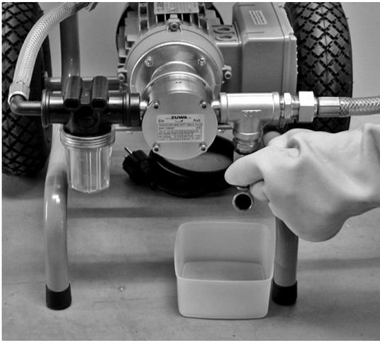
1. Auffanggefäß in ausreichender Größe unter das Druckentlastungsventil stellen. Druckentlastungsventil öffnen.
