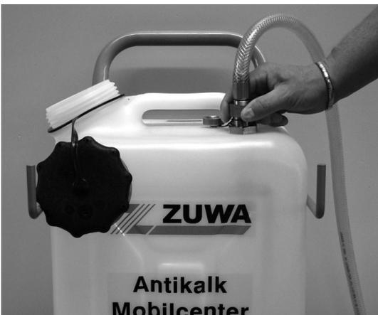
3. Rücklaufschlauch befestigen.
