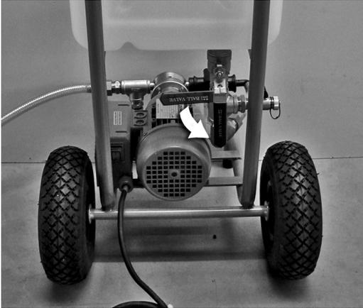
6. Kugelhahn öffnen, Pumpe einschalten und Anlage spülen.
