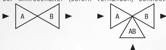
Der Mikroschalter mit Endschaltersignal funktioniert wie ein Schalter, der betätigt wird, wenn das Ventil unter Spannung steht. Auf diese Weise kann jede beliebige Vorrichtung mit diesem Mikroschalter gesteuert werden (z.B. Einschalten einer Umwälzpumpe).
