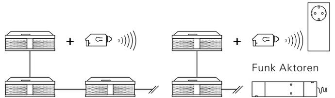
Stummschaltung mittels Funk Sender<sup>1)</sup> [max. 14 Geräte einlernbar] nach örtlicher Alarmierung für ca. 10 Minuten
