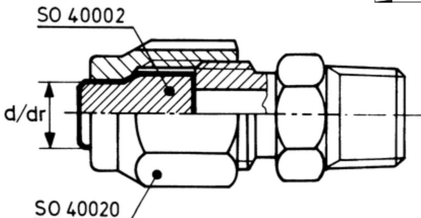
Der Abschlusszapfen lässt sich in jede Verschraubung anstelle eines Klemmrings der gleichen Grösse einsetzen. Wird ein reduzierter Klemmring durch einen Abschlusszapfen ersetzt, so muss immer von der Grösse der Anschlussmutter ausgegangen werden.
