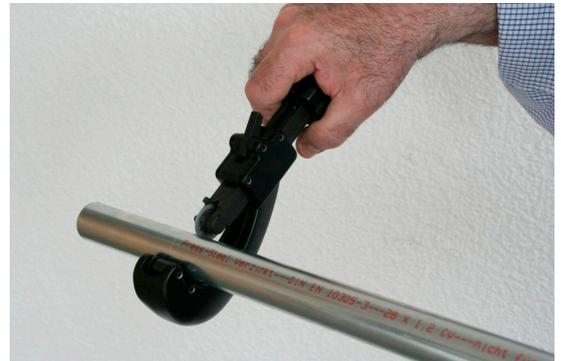
Nach dem Trennvorgang der Edelstahl- und C-Stahlrohre müssen die Rohrenden innen wie außen mit einem handelsüblichen Rohrendgraten für Edelstahl/C-Stahl bearbeitet werden. Dies dient der Sicherheit beim Einführen des Rohrabschnittes in die Pressfittings, da sonst der Dichtring beschädigt werden kann.
