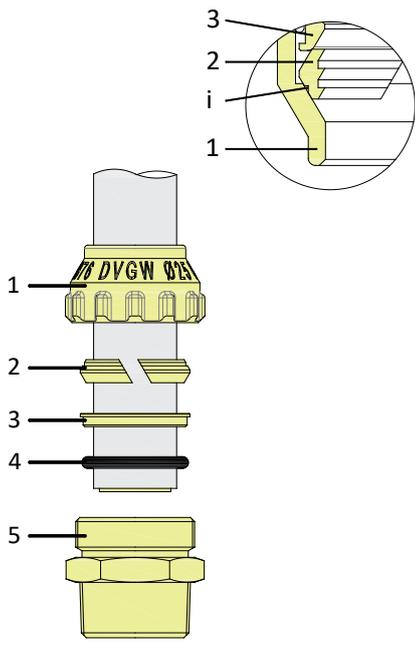
**Connessione del tubo sul raccordo:**
