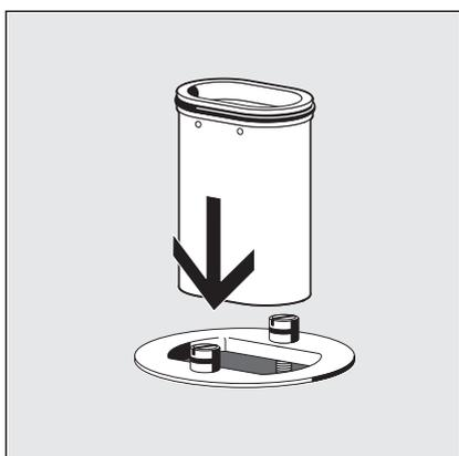
► Tauchrohr einsetzen.
