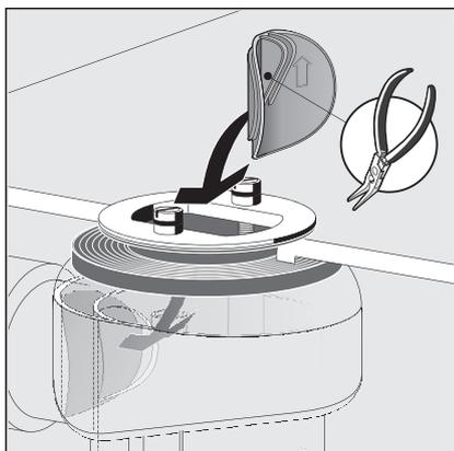
► Verschlussstopfen flächenbündig einsetzen.
