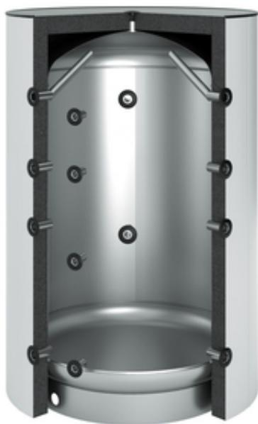
Con questo serbatoio di accumulo si soddisfano le massime esigenze di accumulo di calore. Grazie al suo isolamento altamente efficiente, la perdita di tenuta è significativamente ridotta rispetto allo stoccaggio convenzionale. Il compito del serbatoio tampone è compensare la differenza tra calore generato e calore utilizzato. In questo modo, il generatore di calore può funzionare indipendentemente dal consumo.
