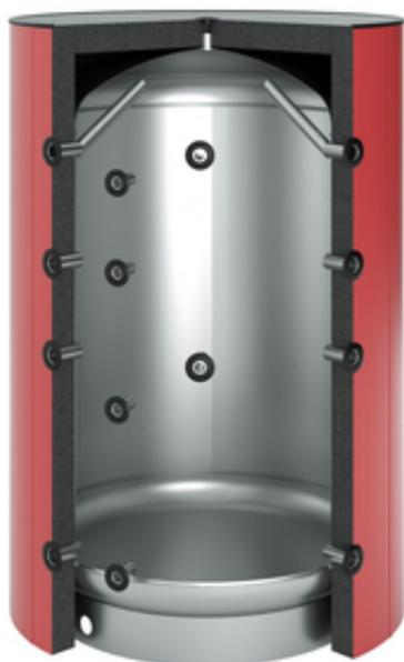
Con questo accumulatore a tampone le più elevate esigenze dell'accumulazione di calore vengono soddisfatte. Grazie al suo isolamento efficiente la perdita di calore è molto più bassa rispetto a quella di accumulatori usuali. Il compito dell'accumulatore a tampone è di bilanciare la differenza tra il calore generato e consumato. In questo modo è possibile comandare i generatori di calore più indipendentemente dal consumo.
