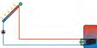
Interner Wärmetauscher, Pumpenlogik
