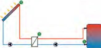
Externer Wärmetauscher, Pumpenlogik
