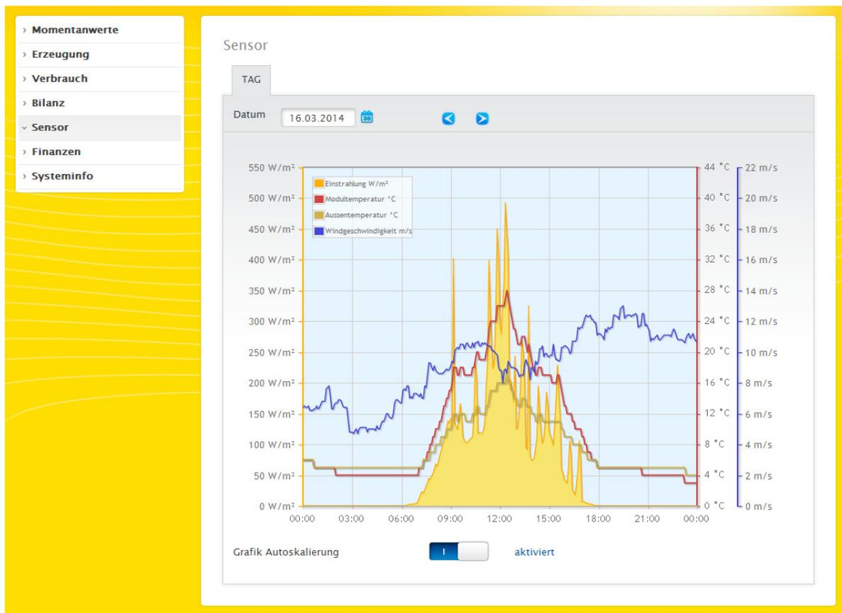
Abb.: Diagramm Werte der Sensorbox
