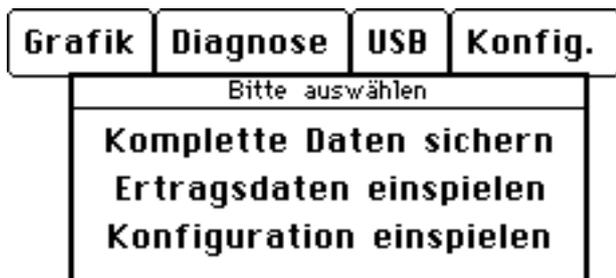
Abb.: Display USB-Datensicherungs-Auswahlmenü
