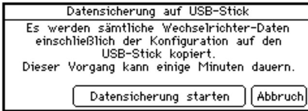
Abb.: Display USB-Datensicherung starten
