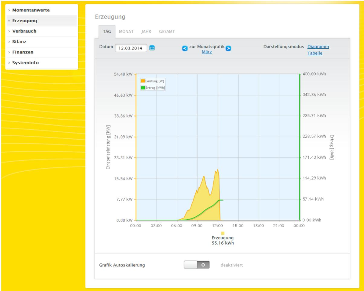
Abb.: Diagramm Tages-Ansicht Erzeugung mit deaktivierter Autoskalierung
