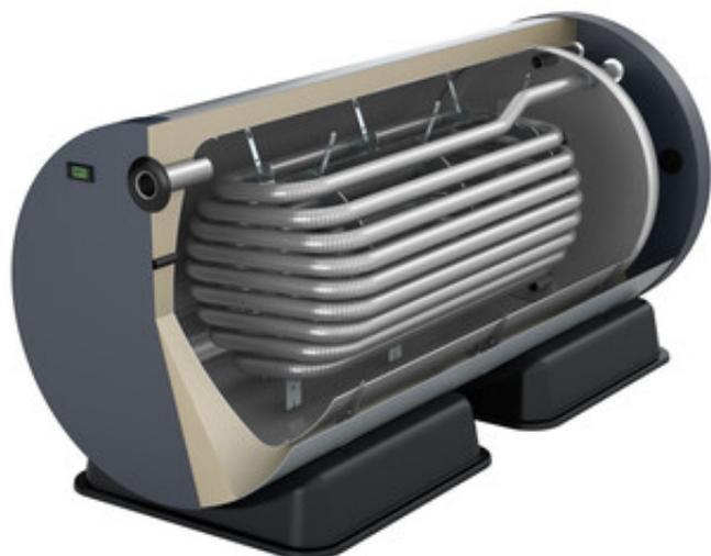
Il design di questi accumulatori differisce fundamentally dai tradizionali accumulatori per acqua calda sanitaria a grande volume. Un tubo corrugato in acciaio inossidabile incorporato separa l'acqua potabile dall'acqua di riscaldamento e serve contemporaneamente come un potente scambiatore di calore. Questo combina i vantaggi di un bollitore tampone con quelli di uno scaldabagno istantaneo.
