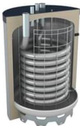
Il design dell'accumulatore d'acqua dolce OEG differisce fundamentally dagli accumulatori d'acqua calda domestici convenzionali e di grande volume. Un tubo corrugato in acciaio inossidabile incorporato separa l'acqua potabile dall'acqua di riscaldamento e serve contemporaneamente come un potente scambiatore di calore. Questo combina i vantaggi di un accumulatore a tampone con quelli di uno scaldabagno istantaneo.
