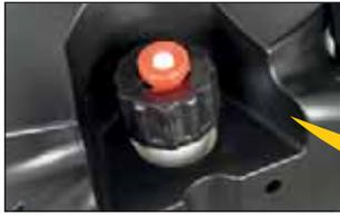
Kolbenmanometer mit eingebautem Sicherheitsventil
