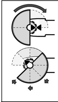
Setzen Sie die Schutzhaube **11** der Abbildung entsprechend auf den Spindelhalsschraubgewinde. Die Dreiecksmarkierungen der Schutzhaube müssen mit den entsprechenden Markierungen am Getriebekopf übereinstimmen.
