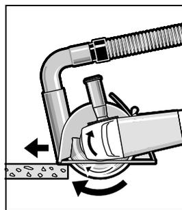
Schakel het elektrische gereedschap in en plaats het met het voorste deel van de geleidingslede op het werkstuk. Duw het elektrische gereedschap verder met een matige voorwaartse beweging, aangepast aan het te bewerken materiaal.
