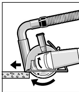
Ligar a ferramenta elétrica e colocá-la com a parte dianteira do carril de guia sobre a peça a ser trabalhada. Empurrar a ferramenta elétrica com avanço moderado, adequado ao material a ser trabalhado.
