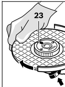
Druk op de asbloekeerknop **2** om de uitgaande as vast te zetten. Om de snelspanmoer vast te draaien, draait u de slijpschijf krachtig met de wijzers van de klok mee.
