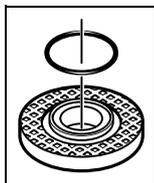
No flange de fixação **7** encontra-se uma gola de centragem (anel circular). **Se o anel circular estiver faltando ou se estiver danificado, terá que substituir sem falta o flange de fixação 7** antes de continuar a usar o aparelho.
