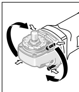
U kunt de machinekop in stappen van 90° draaien. Daardoor kunt u de aan/uit-schakelaar voor bijzondere werkzaamheden in een gunstige bedieningspositie brengen, bijvoorbeeld voor doorslijpwerkzaamheden met de afzuigkap met geleidingslede **20** of voor werkzaamheden met de linkerhand.
