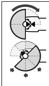
Colocar a capa de proteção **11** sobre a gola do veio, como indicado na figura. As marcas triangulares na tampa de proteção devem coincidir com as respectivas marcas da cabeça da engrenagem.
