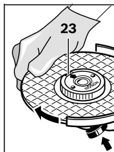
Premir a tecla de bloqueio do veio **2** para imobilizar o veio de retificação. Girar o disco abrasivo fortemente no sentido dos ponteiros do relógio para apertar a porca de aperto rápido.
