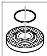
In de opnameflens **7** is rondom de centreekraag een kunststof onderdeel (O-ring) ingezet. **Als de O-ring ontbreekt of beschadigd is**, moet de opnameflens **7** beslist worden vervangen voordat het gereedschap verder wordt gebruikt.
