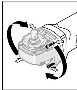
Es posible girar el cabezal del engranaje en pasos de  $90^\circ$ . Ello le permite colocar el interruptor de conexión/desconexión en una posición de operación más cómoda si es Ud. zurdo, o al realizar ciertos trabajos especiales como, p. ej., al tronzar con la caperza de aspiración con el soporte guía 20.
