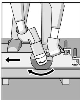
Con l'elettro utensile si deve sempre operare con fresatura bidirezionale. In caso contrario vi è il pericolo che la macchina possa essere spinta in modo **non controllato** fuori della linea di taglio.
