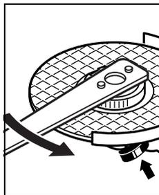
Eine ordnungsgemäß befestigte, unbeschädigte Schnellspannmutter können Sie durch Drehen des Rändelringes entgegen dem Uhrzeigersinn von Hand lösen.
