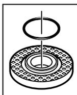
Un joint en plastique (rondelle élastique) est directement monté autour de l'alésage du flasque **7**. **Au cas où cette rondelle élastique fasse défaut ou qu'elle soit endommagée, il faut absolument remplacer la flasque d'entraînement 7 avant de continuer à utiliser l'outil.**
