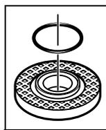
En la base del cuello de centrado de la brida de apoyo **7** va alojada una pieza de plástico (anillo tórico). **Si este anillo tórico faltase o estuviese deteriorado**, es imprescindible reemplazar la brida de apoyo **7** por otra en perfectas condiciones.
