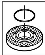
Nella flangia di supporto **7** è applicato intorno al collare di centraggio un elemento di plastica (o-ring). **Se l'o-ring manca oppure è danneggiato, la flangia di supporto 7 deve essere assolutamente sostituita prima di proseguire con l'uso.**
