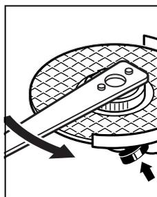
Een op de juiste manier bevestigde en onbeschadigde snelspanmoer kunt u losdraaien door de kartelring tegen de wijzers van de klok in met de hand los te draaien. **Draai een vastzittende snelspanmoer nooit met een tang los, maar gebruik de pensleutel.** Plaats de pensleutel zoals op de afbeelding getoond.
