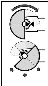
Insertar la caperuza protectora **11** en el cuello del husillo según figura. Las marcas triangulares de la caperuza protectora deberán coincidir con aquellas del cabezal del husillo.
