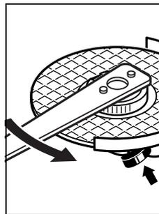
Uma porca de aperto rápido atarraxada de forma correta pode ser solta com a mão; basta girar o anel serrilhado no sentido contrário dos ponteiros do relógio. **Jamais soltar uma porca de aperto rápido com um alicate, mesmo se estiver presa, mas utilizar a chave de dois furos.** Aplicar a chave de dois furos como indicado na figura.
