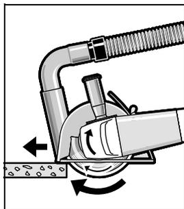
Avviare l'elettro utensile ed applicarlo con la parte anteriore della slitta di guida sul pezzo in lavorazione. Spingere l'elettro utensile avanzando moderatamente ed adattando il movimento al materiale in elaborazione.
