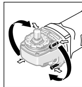
Sie können den Getriebekopf in 90°-Schritten drehen. Dadurch kann der Ein-/Ausschalter für besondere Arbeitsfälle in eine günstigere Handhabungsposition gebracht werden, z. B. für Trennarbeiten mit der Absaughaube mit Führungsschlitten **20** oder für Linkshänder.
