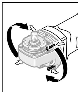
È possibile ruotare la testata ingranaggi in segmenti di  $90^\circ$ . In questo modo l'interruttore di avvio/arresto può essere posizionato, per casi operativi particolari, in una posizione di maneggio più favorevole, p. es. per lavori di troncatura con la cuffia di aspirazione con la slitta di guida 20 oppure per mancini.
