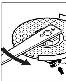
Una tuerca de fijación rápida, correctamente montada, puede aflojarse a mano girando el anillo moleteado en sentido contrario a las agujas del reloj.
