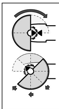
Montez le capot de protection **11** sur la tête de broche conformément à la figure. Les marques triangulaires se trouvant sur le capot de protection doivent coïncider avec les marquages correspondants sur la tête d'engrenage.
