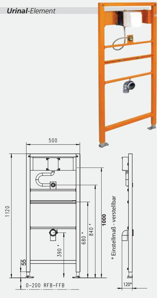
selbsttragend, als Vorwandinstallation für den Einbau vor Massiv- oder Leichtbauwände, als Inwandinstallation für den Einbau in Leichtbau- oder Holzständerwänden und in UW-Profile, bestehend aus:
