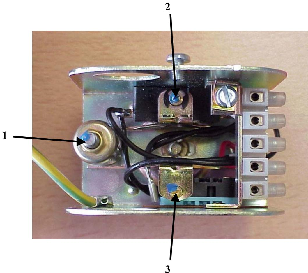
An **Verstellschraube 1.** wird der *obere Arbeitspunkt* verstellt. Wird die Schraube rechts herum gedreht erhöht sich der Druck. Bei Drehung links herum wird der Druck gesenkt. (Eine Umdr. Bewirkt eine Verstellung um 0,2 bar)
