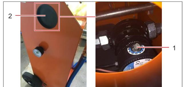
Abb. 14: Entlüftungsmodus der Umwälzpumpe
