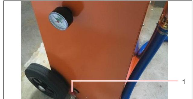
Abb. 17: Warmwasserbereiter entleeren
