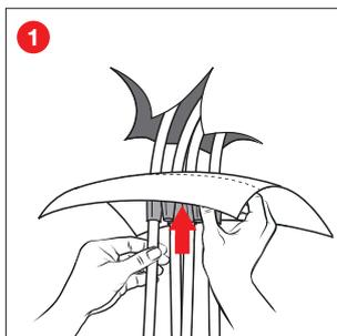
1 Kabel schräg anschneiden und die Membranen der Manschette durchstoßen.
