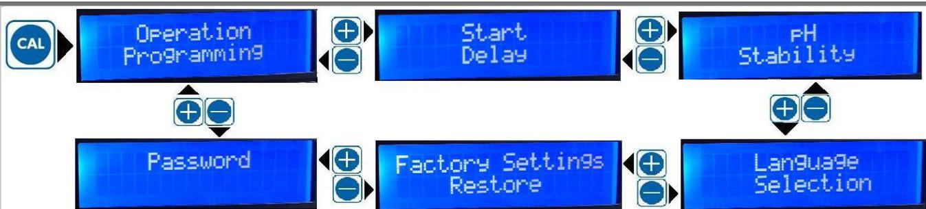
Zum Aufrufen des Programmier-Menüs muss die **CAL**-Taste kurz gedrückt werden. Mit **+** und **-** schalten Sie die Auswahlmöglichkeiten durch. Um in ein Untermenü zu gelangen muss kurz die **CAL**-Taste gedrückt werden.
